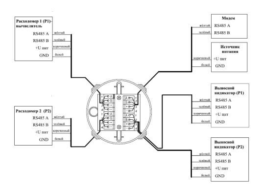
Схема подключения выносных индикаторов для теплосчетчиков с тремя расходомерами и двумя коммутационными коробками
