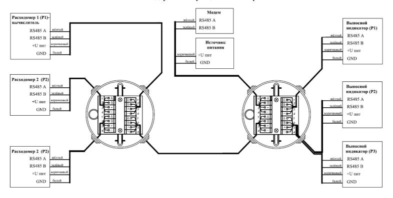
Количество подключаемых выносных индикаторов и расходомеров определяется комплектностью заказа
