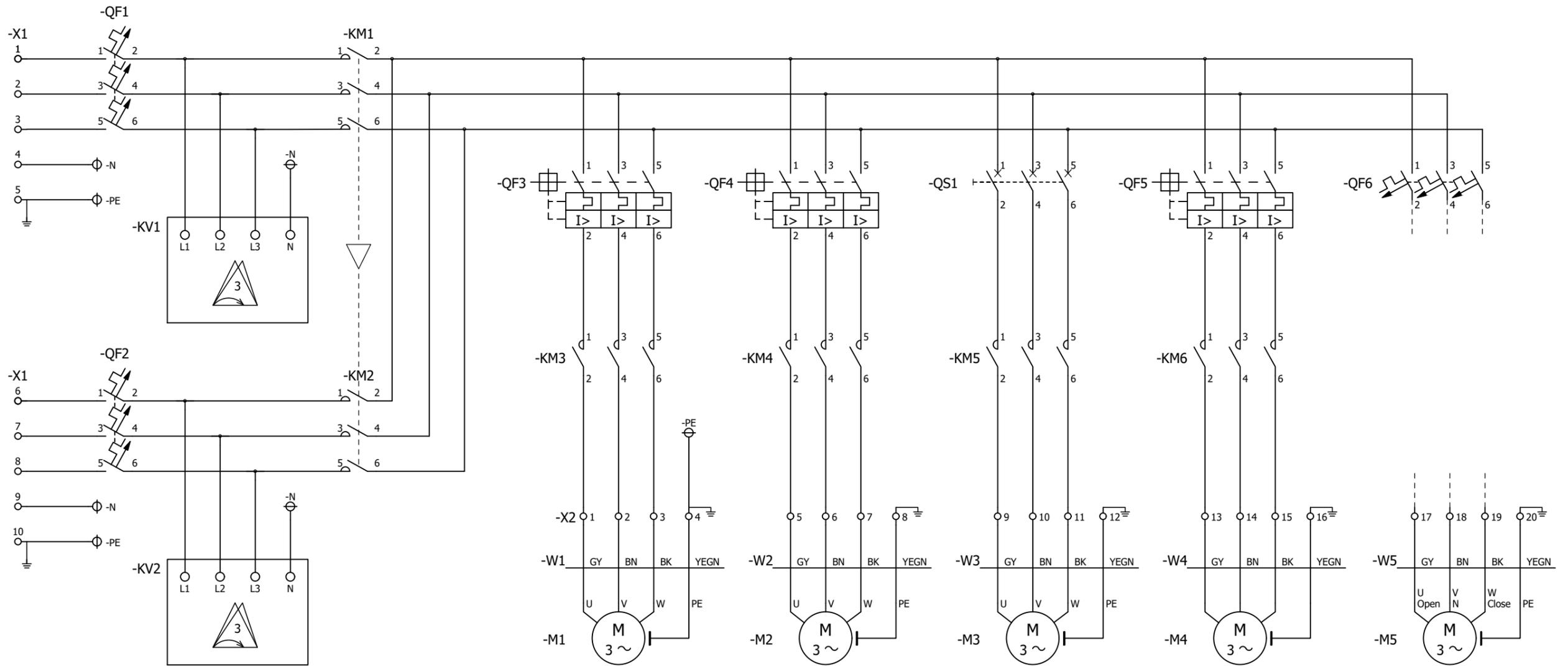
Насос пожарный      Насос пожарный      Насос пожарный (резервный)      Насос подкачки      Задвижка обводная 380В или 220В
