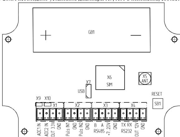
Рис. 8.1 Схема клеммников счетчика
