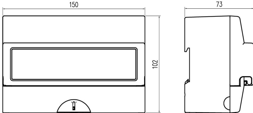
Счетчик устанавливается на DIN-рейку.
