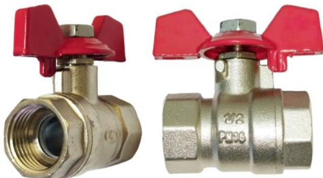
Краны применяются в качестве запорной арматуры на трубопроводах систем холодного (в том числе и питьевого), горячего водоснабжения, отопления, а также на технологических трубопроводах, транспортирующих жидкости, не агрессивные к материалам крана. Краны шаровые изготавливаются из прочной латуни, уплотнительный элемент выполнен из фторопласта.
